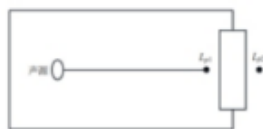
图 8.1 室内声源等效为室外声源图例
